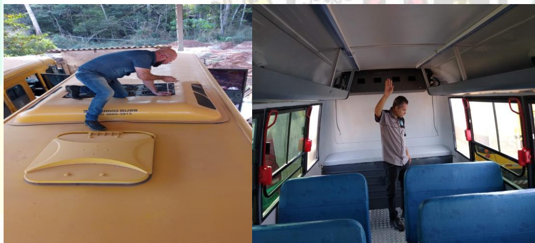
Figura 106 - Instalação de sistema de ar-condicionado em 6 (seis) ônibus escolares em 2022/2023.
